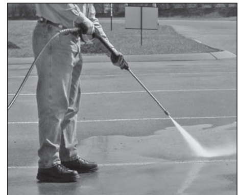
Figura 20 - Ángulo mejor para limpiar una superficie
