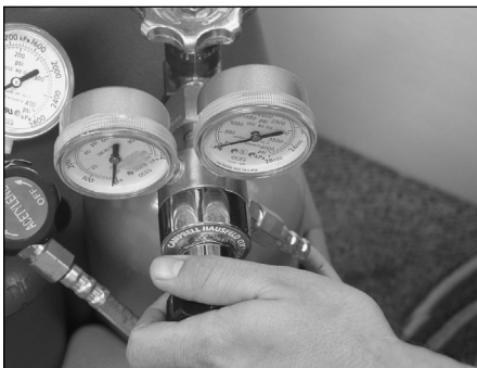
Figura 11 - Ajuste del regulador del cilindro de oxígeno
