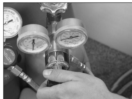
Figure 11 - Ajuster le régulateur de la bouteille d'oxygène
