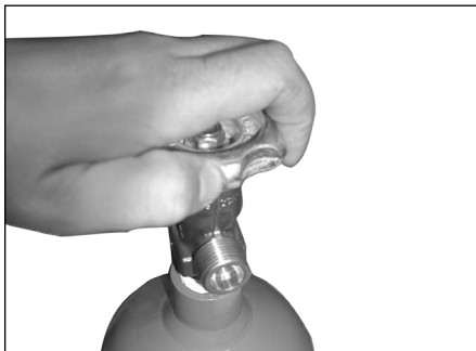
Figura 1 - Para abrir y cerrar la válvula por primera vez para disipar contaminantes
