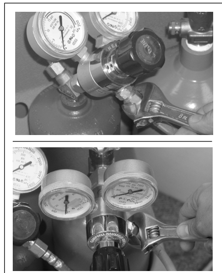
Figure 3 - Connexion acétylène (haut) et connexion d'oxygène (bas)
