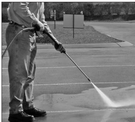
Figura 11 - Mejor ángulo de limpieza de superficies
