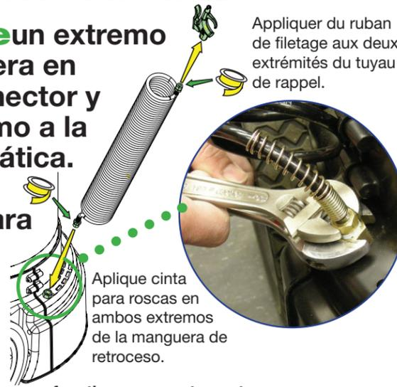
Appliquer du ruban de filetage aux deux extrémités du tuyau de rappel.
