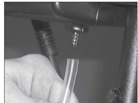
Figure 3 - Fixez le tube d'aspiration à la tétine
