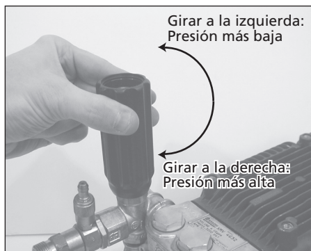
Figura 8 - Ajuste de la presión de la bomba de árbol de distribución
