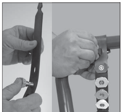
Figure 9 - Insérer les buses de pulvérisation dans le support pour buses en caoutchouc
