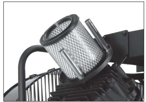
Figura 12 - Filtro de aire
