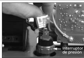
Figura 3 - Cómo retirar los cables del interruptor de presión
