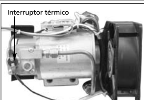
Figura 2 - La bomba/motor puede tener un interruptor térmico en el cabezal de la bomba
