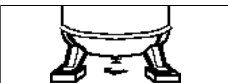
Figure 6 - Ouverture du Robinet de Purge
