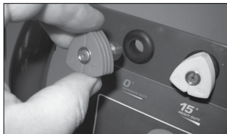
Figura 11 - Inserte las boquillas de pulverización en el soporte
