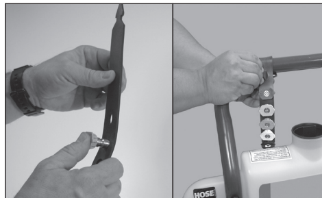
Figura 8 - Inserte las boquillas de pulverización en el soporte de caucho
