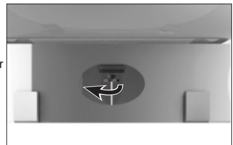
Figure 10 - Drain manuel du réservoir
