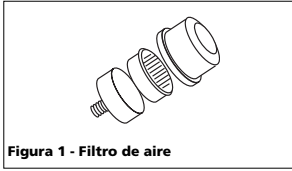
Figura 1 - Filtro de aire
