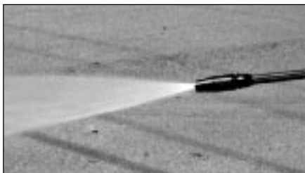
Figura 4 - Patrón en abanico ancho
