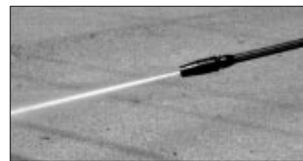
Figure 3 - Jet étroit à impact élevé
