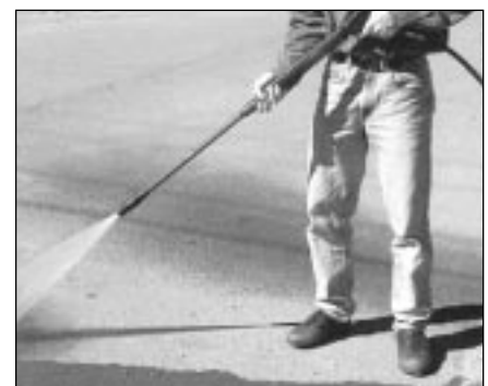
Figura 5 - Ángulo óptimo a la superficie de limpieza
