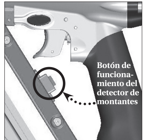
Figura 22- Botón de funcionamiento del detector de montantes
