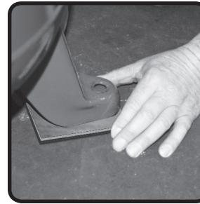
**Placez** les coussinets de vibrations pré-percés sous chaque pied (numéro de pièce HDA71200AV) pour éviter toute vibration inutile qui pourrait endommager l'appareil. La plaque de métal doit être placée directement sous le pied du compresseur avec les deux coussinets de caoutchouc entre la plaque et le sol.
