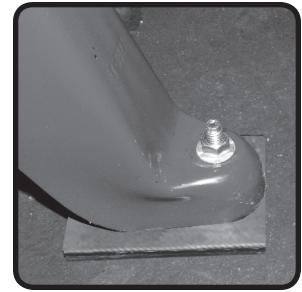
**Resserrez** l'érou en utilisant la clé à cliquet avec une douille de 14,3 mm (9/16 po) jusqu'à ce que l'ancrage soit placé (utilisez les spécifications de couple d'installation du boulon utilisé). **Desserrez** l'érou pour laisser un écart de 1,6 mm (1/16 po) pour le relâchement des contraintes durant l'utilisation de l'appareil.
