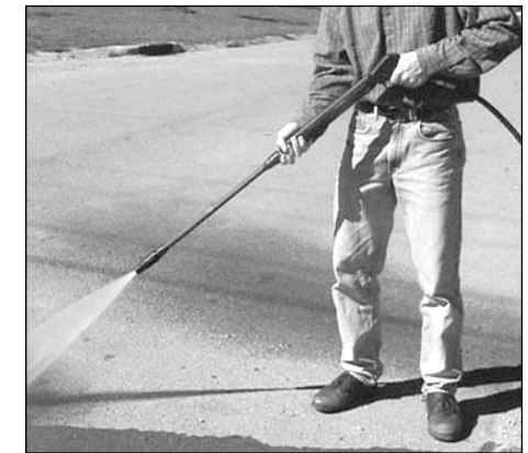
Figure 18 - Mejor ángulo de limpieza de superficies
