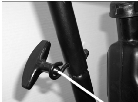
Figure 2 - Fixez la corde de moteur
