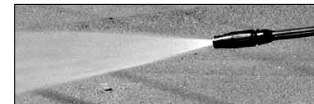
Figure 17 - Patrón de abanico amplio
