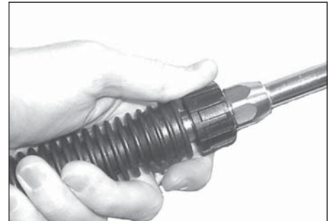
Figure 7 - Fixer la lance au pistolet
