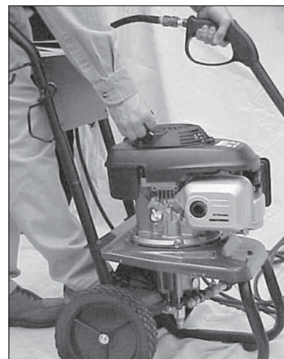
Figure 12 - Démarrage du moteur
