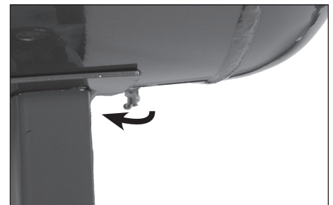
Figure 16 - Drain de réservoir manuel
