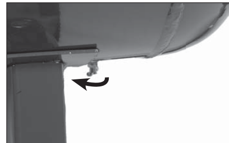
Figure 10 - Drain de réservoir manuel
