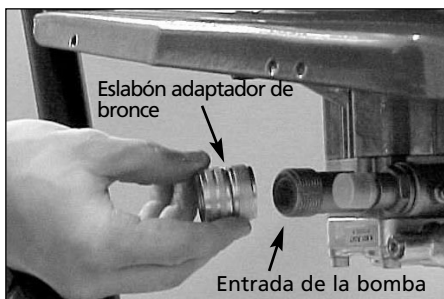
Figura 5 - Conecte el eslabón adaptador a la bomba
