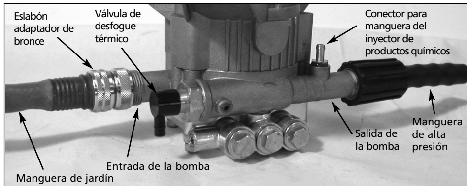
Figura 2 - Conexión de la bomba
