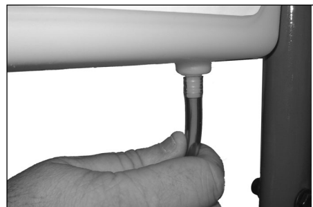
Figure 3 - Fixez le tube d'aspiration à la tétine
