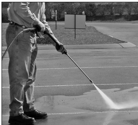
Figure 12 - Angle optimum par rapport à la surface à nettoyer
