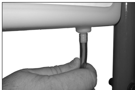
Figura 3 - Conecte el tubo de succión al conector dentado
