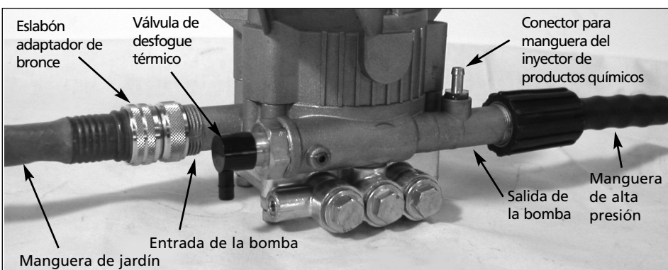
Figura 2 - Conexión de la bomba
