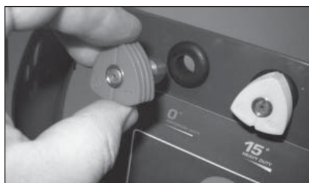
Figure 6 - Insérer des buses de pulvérisation dans le support
