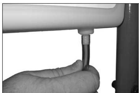
Figure 3 - Fixez le tube d'aspiration à la tête
