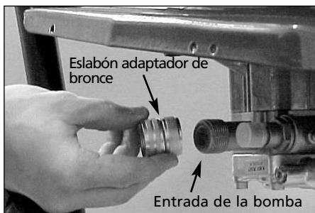
Figura 5 - Conecte el eslabón adaptador a la bomba
